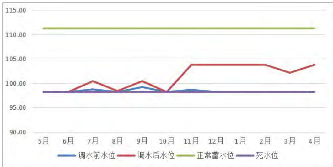
图 6.10-51 江口水库枯水年的库区水位变化 单位: \text{m}
