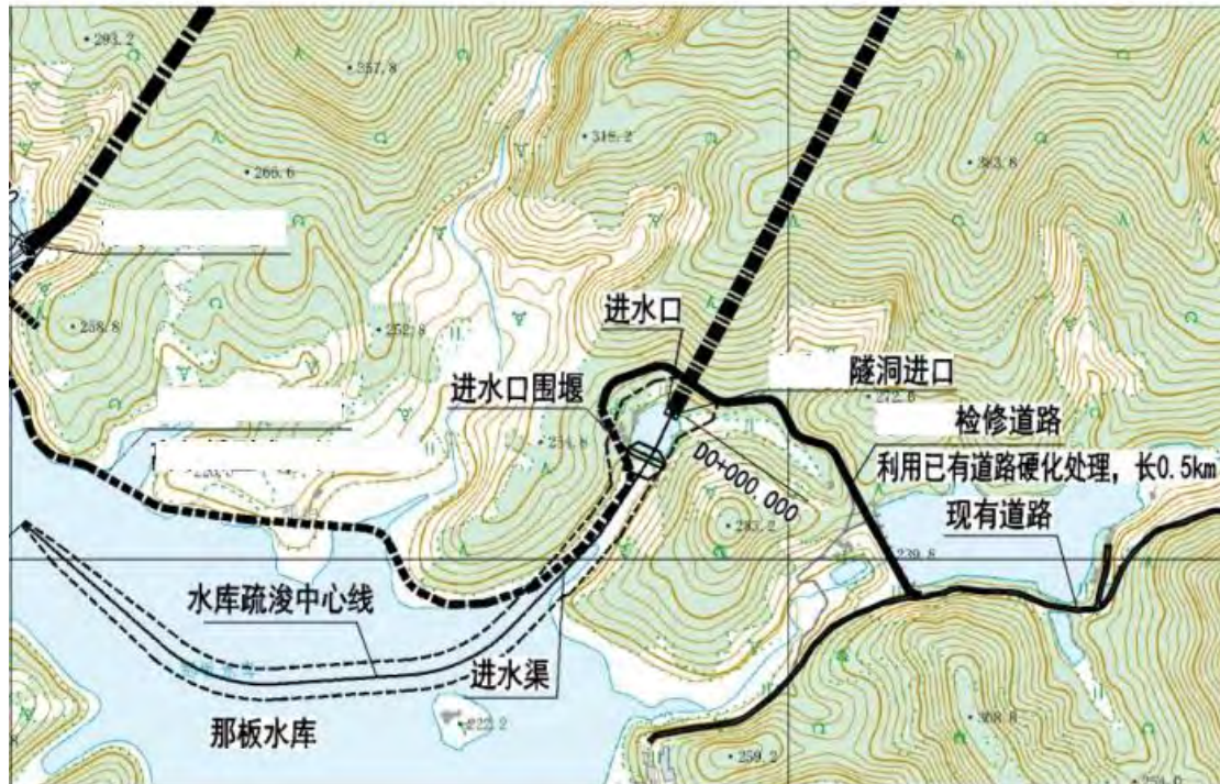
图 8.5-3 那板水库取水口布置示意图
