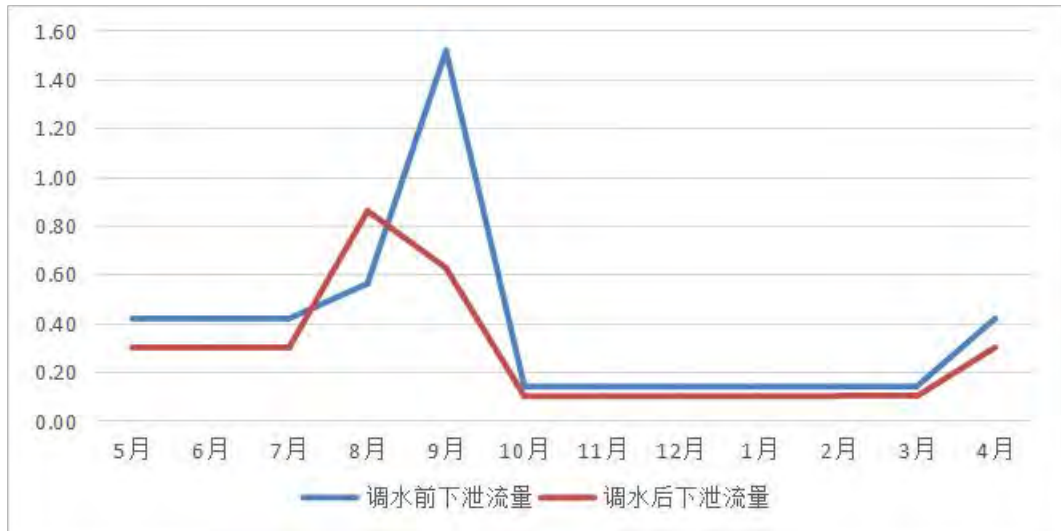
图 6.10-53 江口水库平水年的下泄流量过程 单位: \text{m}^3/\text{s}
