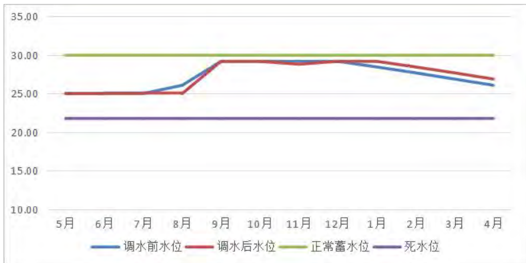
图 6.10-45 牛尾岭水库丰水年的库区水位变化 单位: m
