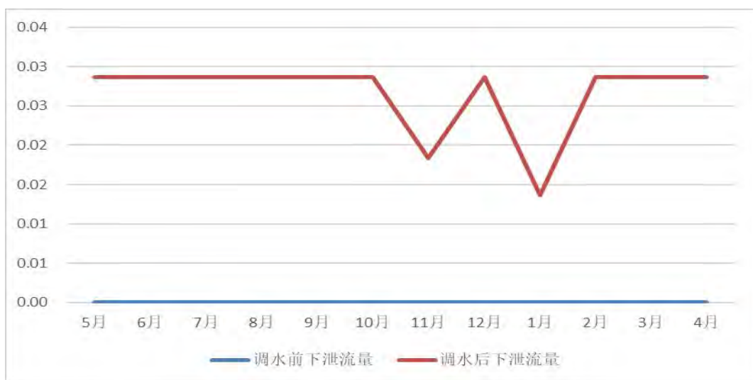
图 6.10-62 大马鞍水库枯水年的下泄流量过程 单位: \text{m}^3/\text{s}
