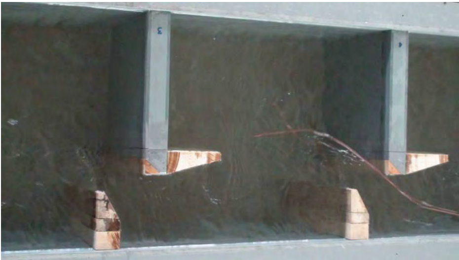
图 8.5-7 C 型隔板水流流态
