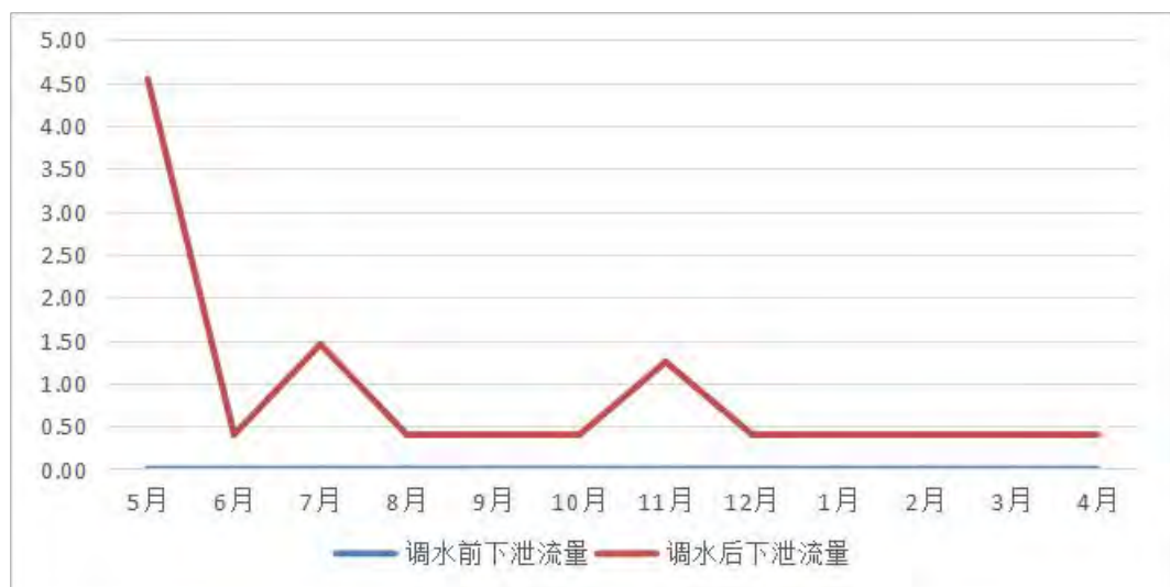
图 6.10-2 灵东水库枯水年的下泄流量过程 单位： \text{m}^3/\text{s}
