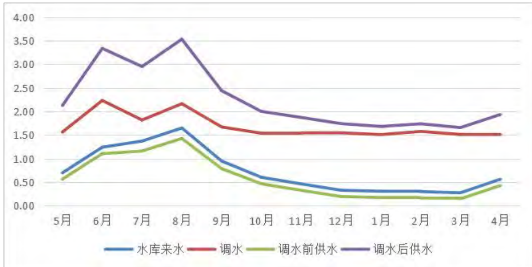
图 6.10-46 牛尾岭水库多年平均的供水过程 单位: m³/s
