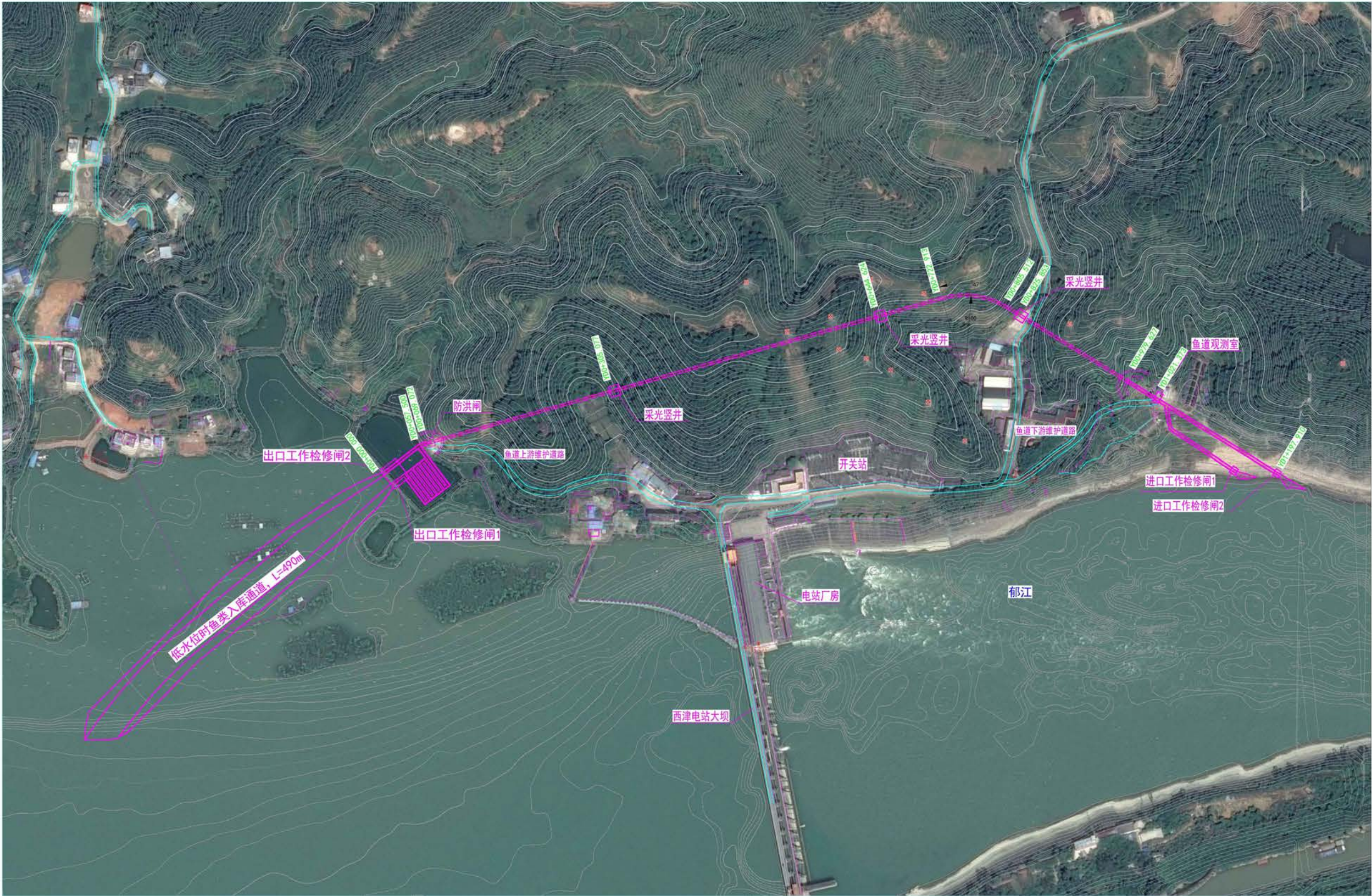
图 8.5-5 方案一：左岸隧洞方案鱼道平面布置图
