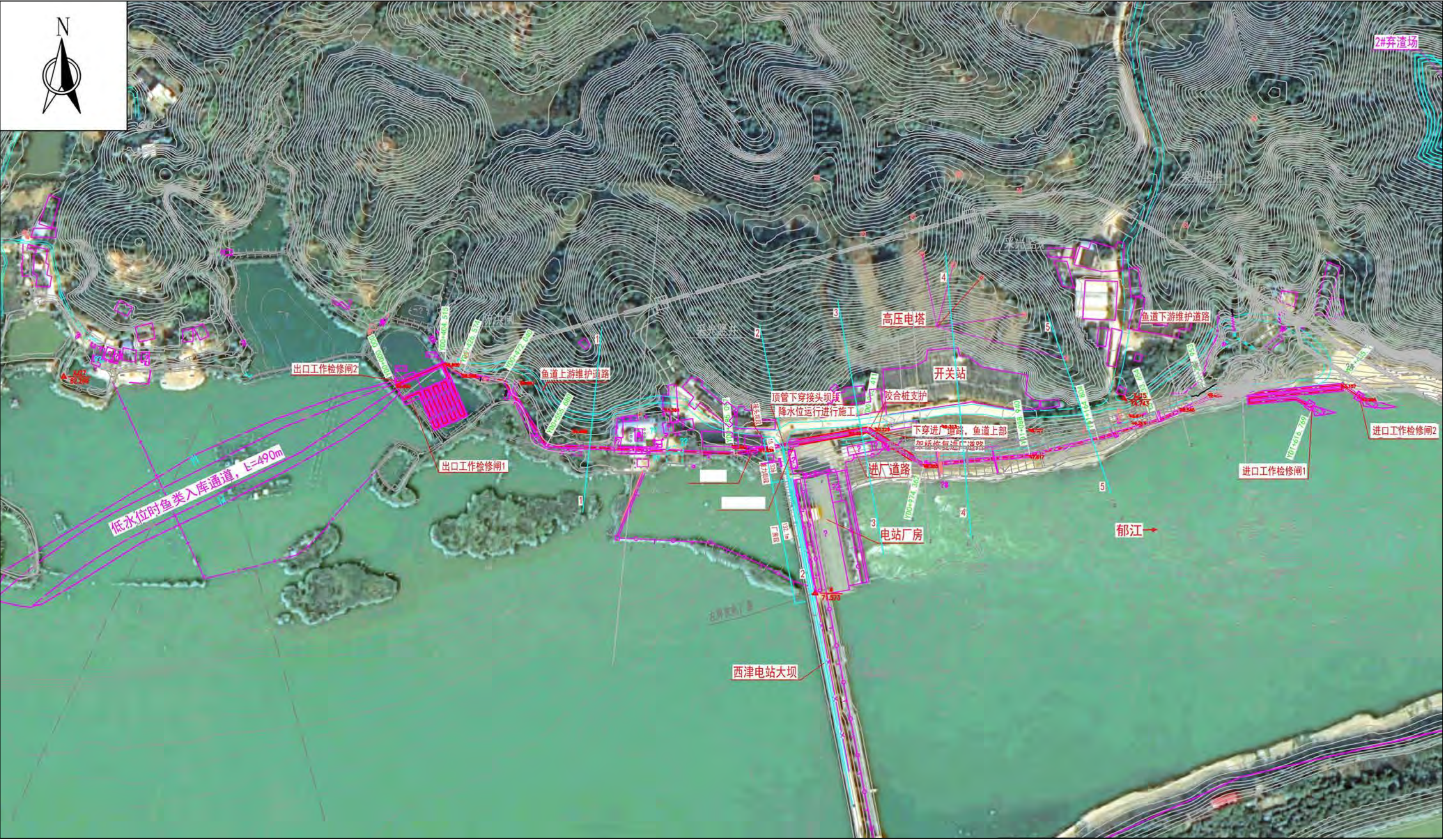
图 8.5-6 方案二：左岸明挖式鱼道方案平面布置图
