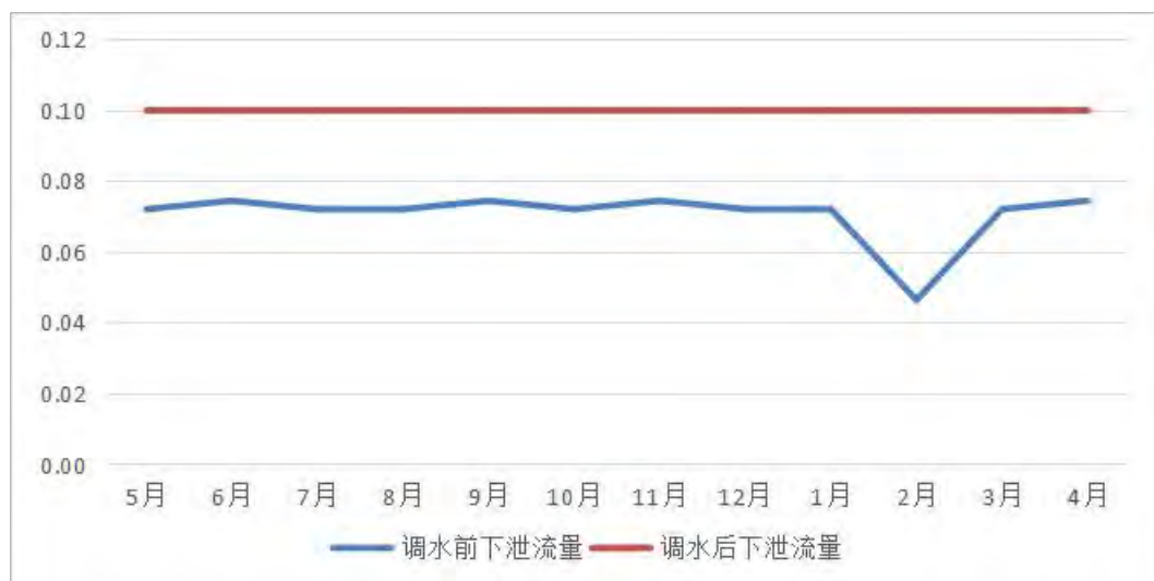
图 6.10-41 牛尾岭水库平水年的下泄流量过程 单位: m³/s
